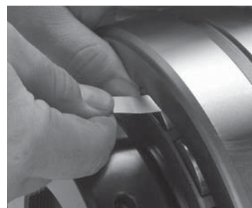
Fig. 18. Medida del RIC antes de la instalación.
