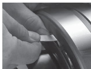
Fig. 14. Medida del RIC antes de la instalación.
