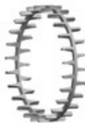
Abb. 5: Einteiliger, gefräster, rollkörpergeführter Messing-Fingerkäfig.
