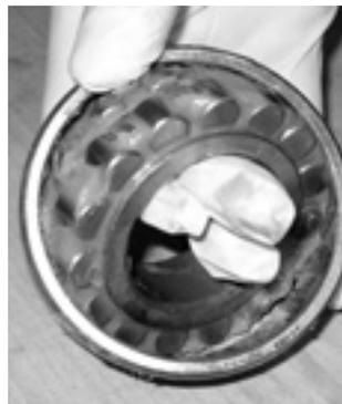
**Abb. 21: Schmierfett kann einfach von Hand aufgetragen werden.**
