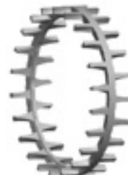
Abb. 6: Einteiliger, gefräster, innenringgeführter Messing-Fingerkäfig.
