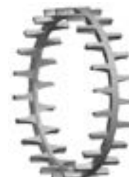
Rys. 6. Kosz jednoczęściowy typu palcowego z mosiądzu obrabionego maszynowo, prowadzony na pierścieniu wewnętrznym.
