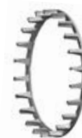
Rys. 7. Kosz dwuczęściowy typu palcowego z mosiądzu obrabionego maszynowo, prowadzony na pierścieniu wewnętrznym.
