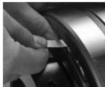
Fig. 18. Mesure du jeu radial interne avant l'installation.
