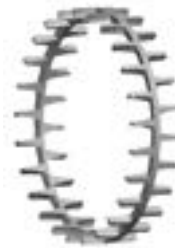
Fig. 5. Cage monobloc à cames ou ergots, usinée en laiton, guidée sur les rouleaux.
