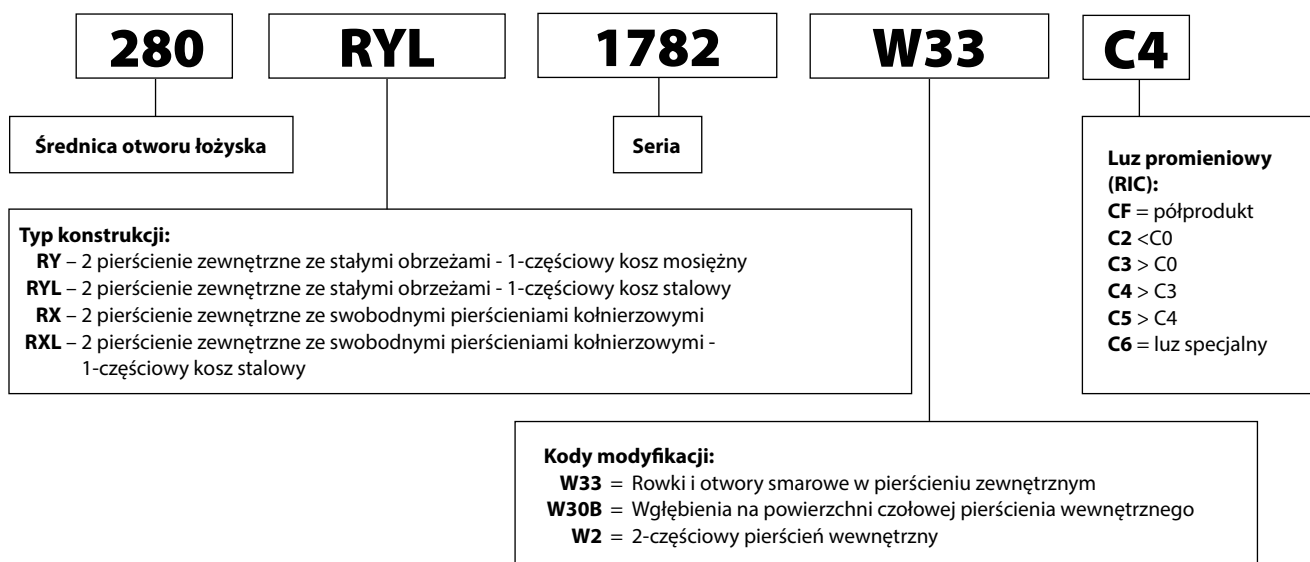
Rys. 21. Oznaczenia czterorzędowych łożysk walcowych.
