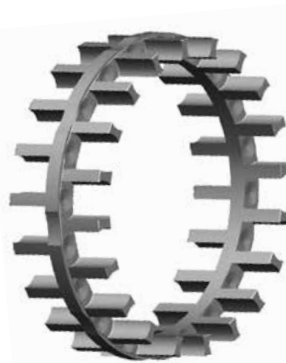
Rys. 5. Kosz jednoczęściowy typu palcowego.
