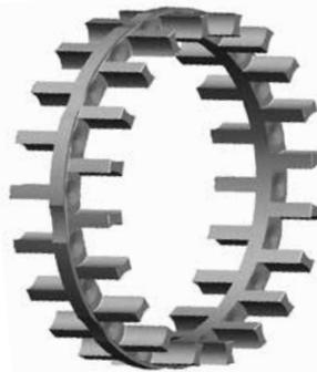
Fig. 5. Jaula de una pieza, tipo lengüeta.
