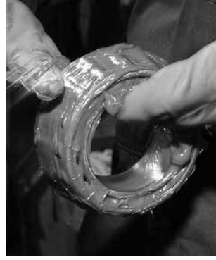
Şekil 14. Gresler kolayca elle doldurulabilir.
