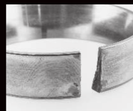
Ajuste com folga resultando em capa esticada e quebrada
