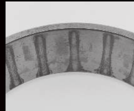
Corrosão leve na pista externa
