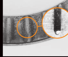
Falso Brinell pesado na pista externa
