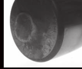
Extremidade do rolo com desgaste adesivo
