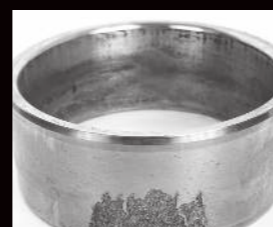
Descascamento GSC (Concentração de tensão geométrica) no anel interno
