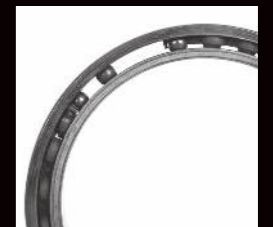
Dano no porta-rolos por travamento do rolamento
