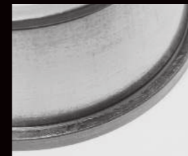
Dano por calor no encosto e extremidade do rolo
