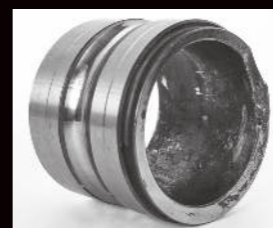
Anel interno estendido fraturado com colar de trava devido a eixo de tamanho reduzido
