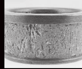
Descascamento grave por cargas pesadas
