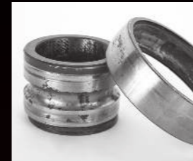
Corrosão e ataque químico avançados
