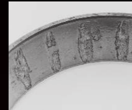
Descascamento espaçado causado pelo rolo
