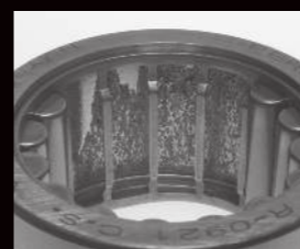
Descascamento GSC (Concentração de tensão geométrica) no anel externo
