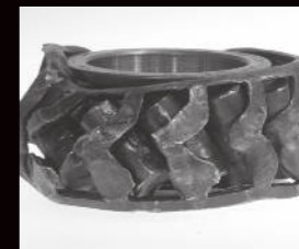
Deformação de pista por geração excessiva de calor
