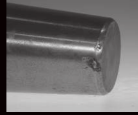
Rolo com queimaduras por arco elétrico
