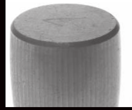
Estriamento causado por corrente elétrica
