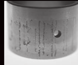
Ataque químico e corrosão
