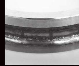
Descascamento por fadiga por pré-carga excessiva
