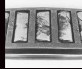
Rolos com fadiga grave por carga pesada
