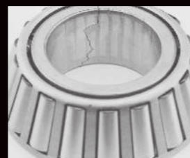
Fratura no anel interno
