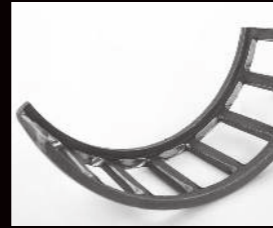
Desgaste nas extremidades pequenas da bolsa do porta-rolos e nas pontes dos rolos
