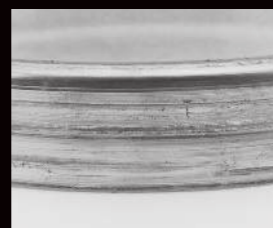
Ajuste com folga do anel externo no cubo de roda
