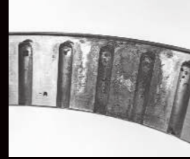
Falso Brinell pesado na pista externa
