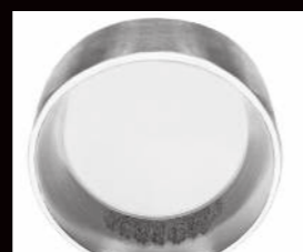
Trajectoria elíptica do rolo causada por desalinhamento
