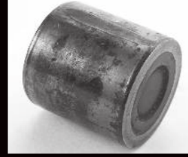
Rolo aplanado, desgaste adesivo e por deslizamento na superfície da pista
