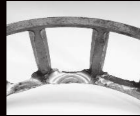
Desgaste na bolsa do porta-rolos por movimento excessivo do rolo
