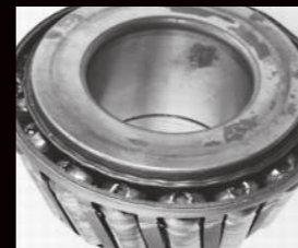
Dano por estriamento na extremidade do rolo
