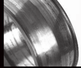
Desgaste adesivo no anel interno do rolamento
