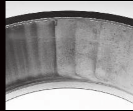
Marcas de recorte na capa causadas por folga lateral excessiva
