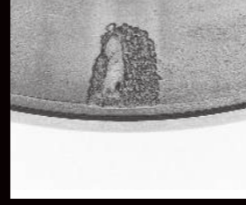
Resultando em descascamento localizado na pista
