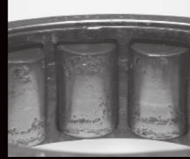
Fadiga resultante de cargas pesadas
