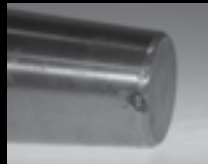
Rolo com queimaduras por arco elétrico
