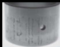
Ataque químico e corrosão
