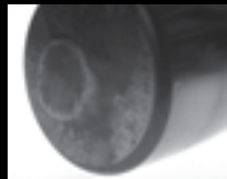
Extremidade do rolo com desgaste adesivo
