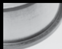
Dano por calor no encosto e extremidade do rolo
