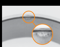
Marcas no anel externo
