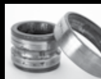
Corrosão e ataque químico avançados
