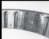
Falso Brinell pesado na pista externa
