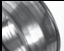
Desgaste adesivo no anel interno do rolamento
