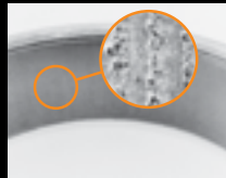
Estriamento por arco elétrico
