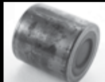
Rolo aplanado, desgaste adesivo e por deslizamento na superfície da pista
