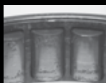
Fadiga resultante de cargas pesadas
