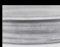
Ajuste com folga do anel externo no cubo de roda
