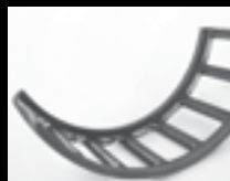
Desgaste nas extremidades pequenas da bolsa do porta-rolos e nas pontes dos rolos
