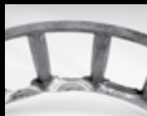
Desgaste na bolsa do porta-rolos por movimento excessivo do rolo
