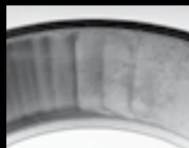
Marcas de recorte na capa causadas por folga lateral excessiva
