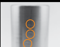
Entailles et enfoncements causés par une manipulation violente
