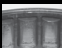
Ecaillage résultant de charges lourdes
