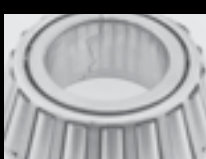
Fracture de la bague intérieure
