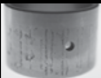
Attaque et corrosion
