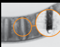
Usure causée par des vibrations
