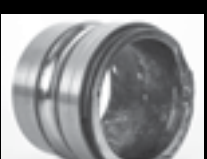
Rupture de la bague intérieure munis d'un collier excentrique de serrage causée par un diamètre d'arbre trop faible.
