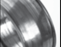
Usure adhésive sur la bague intérieure du roulement
