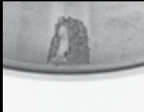
Ecaillage localisé sur le chemin de la bague extérieure résultant d'une concentration de contraintes créée par le pincement
