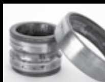
Corrosion et attaque avancées
