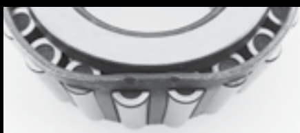
Déformation de la cage
