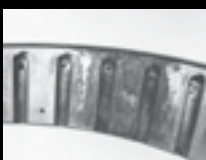
Usure causée par un mouvement axial relatif entre les rouleaux et le chemin.
