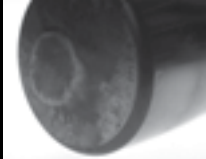
Extrémité du rouleau avec usure adhésive
