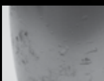
Contamination par des particules dures
