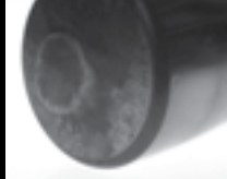
Cap de rolă cu uzură de aderență
