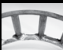
Uzura locașului coliviei din cauza mișcării excesive a rolei
