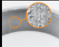
Canelare datorată arcului electric
