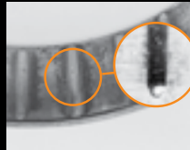
Amprentare falsă masivă pe calea de rulare a inelului exterior
