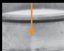
Marcaj martor pe diametrul exterior al rulmentului, apărut în urma deformărilor locale din carcasă
