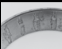
Exfoliere echidistantă în zona de contact a rolei cu calea de rulare
