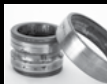
Coroziune și oxidare avansată
