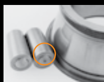
Contaminare cu particule fine
