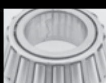
Fractură pe inelul interior
