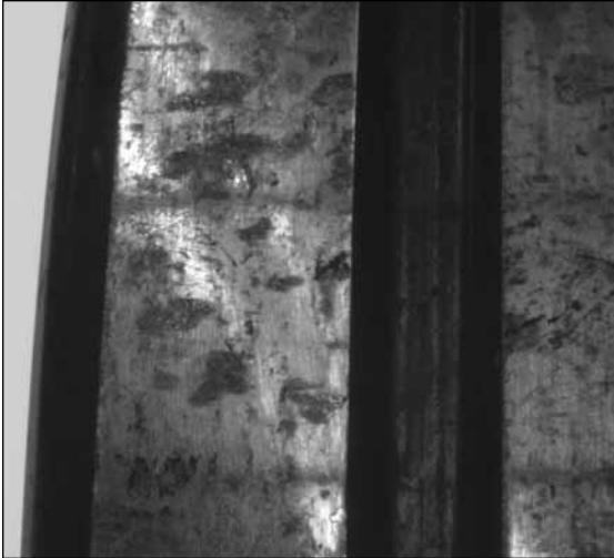
Fig. 46. Un alojamiento desgastado ocasionó que este rodamiento se desajustara y oscilara durante el funcionamiento. Como consecuencia, el metal de este anillo exterior del rodamiento esférico se deterioró.
