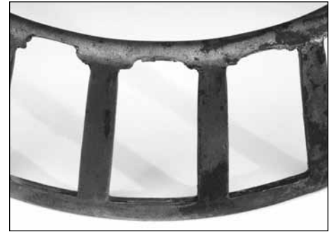
Fig. 34. El alto desgaste en la pequeña zona de carga es común cuando hay exceso de juego lateral.
