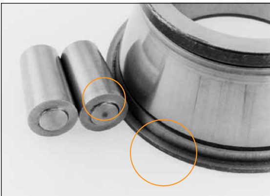
Fig. 3. La contaminación por finas partículas ocasionó desgaste abrasivo en este rodamiento de rodillos cónicos.
