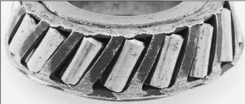
Fig. 44. La unión y el desplazamiento de estos rodillos cónicos se originó por la compresión del anillo de la jaula durante la instalación o por una interferencia durante el funcionamiento.
