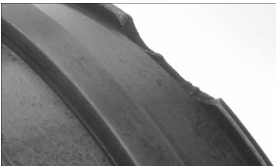
Fig. 40. Esta pista interna de un rodamiento de rodillos esféricos muestra un pequeño reborde con una fractura como consecuencia del uso incorrecto de las herramientas de instalación.
