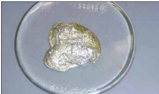
Fig. 67. Grasa retirada de un rodamiento con escasez de grasa que muestra un resto de metal brillante del rodamiento.
