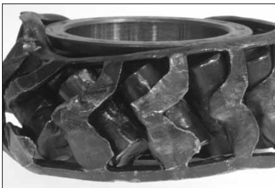
Fig. 22. Nivel 4: este es un ejemplo del bloqueo total del rodamiento.
