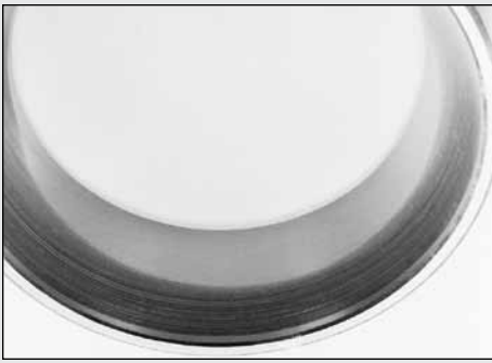
Fig. 36. La deflexión, el maquinado incorrecto o el desgaste de los asientos del rodamiento provocaron un camino irregular del rodillo en este anillo exterior de un rodamiento de rodillos cónicos.
