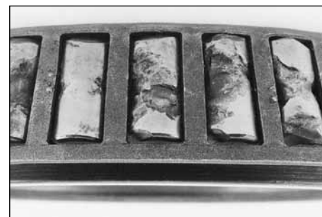
Fig. 30. Este rodamiento de rodillos cónicos con sobrecarga pesada presenta un astillamiento por fatiga severo y prematuro en los rodillos. La carga era tan pesada que las piezas grandes de metal rompieron los rodillos.
