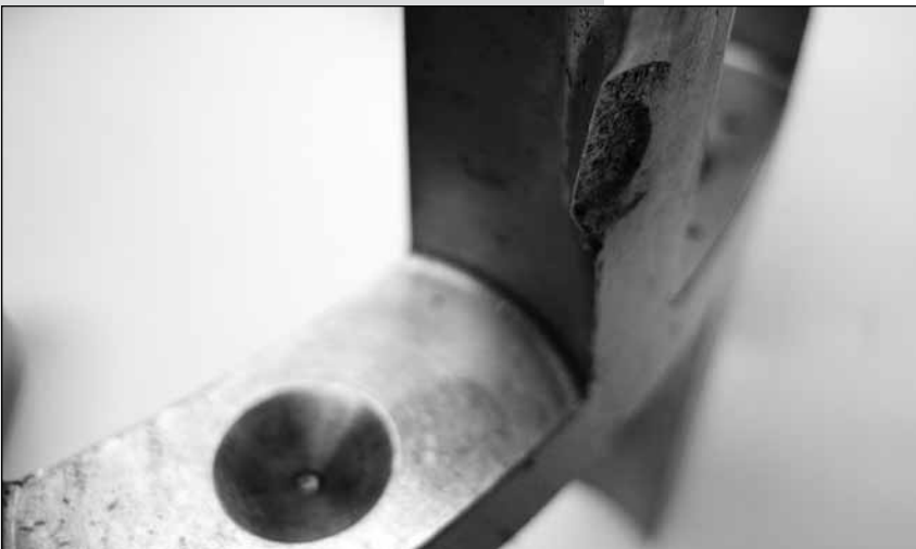
Fig. 45. Malas prácticas de manipulación provocaron una mella profunda en el puente de la jaula de este rodamiento de rodillos esféricos. Este daño producirá la incorrecta rotación del rodillo, el posible deslizamiento del rodillo, aumento de temperatura y reducción de la vida útil.
