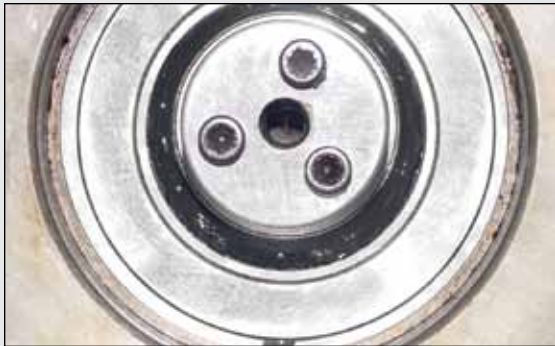
Fig. 66. La grasa "limpia" que sale levemente de un rodamiento durante el arranque suele ser aceptable. La grasa es húmeda y sale de forma pareja. Si esta leve purga no causa problemas, déjela, ya que funciona como un sello de barrera efectivo.
