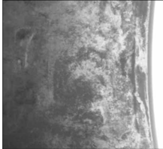
Fig. 47. Aquí se muestra la corrosión por frotamiento clásica que resulta de una mala práctica de ajuste. El movimiento relativo debajo de la carga entre el rodamiento y su asiento provocó este desgaste y esta corrosión.
