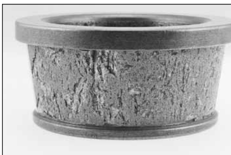
Fig. 29. Las cargas pesadas y velocidades bajas originaron una película de lubricante insuficiente en este cono de rodamiento de rodillos cónicos.
