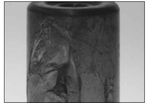
Fig. 28. La sobrecarga en este rodamiento de rodillos cilíndricos ocasionó una fractura en la superficie de los rodillos.
