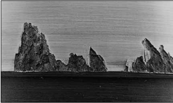
Fig. 23. Desalineación, deflexiones o cargas pesadas en este rodamiento de rodillos cónicos ocasionaron un astillamiento por concentración de tensión geométrica.
