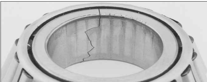
Fig. 53. Un eje con defecto de circularidad o demasiado grande ocasionó esta fractura en el cono de un rodamiento de rodillos cónicos.
