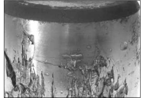
Fig. 25. Rodamiento de rodillos esféricos con fractura y astillamiento profundo debido a cargas pesadas.
