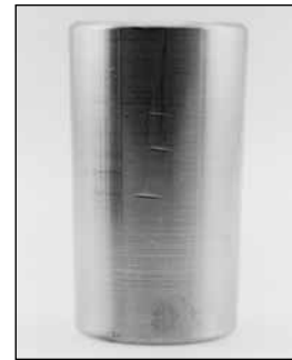
Fig. 39. La manipulación o instalación brusca provocó estrías y mellas en este rodillo de un rodamiento cónico.
