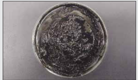
Fig. 65. Esta caja de Petri contiene grasa muy oxidada que desbordó de un rodamiento llenado en exceso. La grasa con alta oxidación suele tener un color negro y un aroma a quemado que se distingue fácilmente. Además, su consistencia es más dura.
