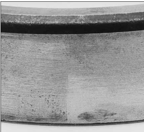
Fig. 48. Las marcas en el diámetro externo de esta taza se originaron por un punto alto en el alojamiento. La pista de la taza está astillada en el punto que coincide con el punto en el exterior de la taza marcado por contacto intenso.
