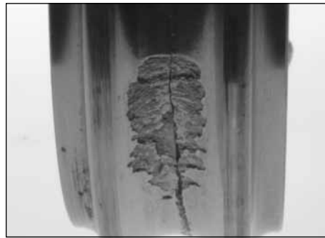
Fig. 27. Este anillo interior del rodamiento de bolas muestra un astillamiento por fatiga debido a cargas pesadas. La fractura es un tipo de daño secundario.
