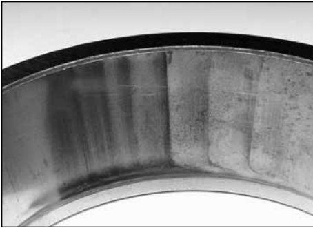
Fig. 32. Este tipo de marcas en la taza son comunes cuando hay exceso de juego lateral. Ocurre cuando rodillos sin carga entran en la pequeña zona de carga y son de pronto sujetos a altas cargas.
