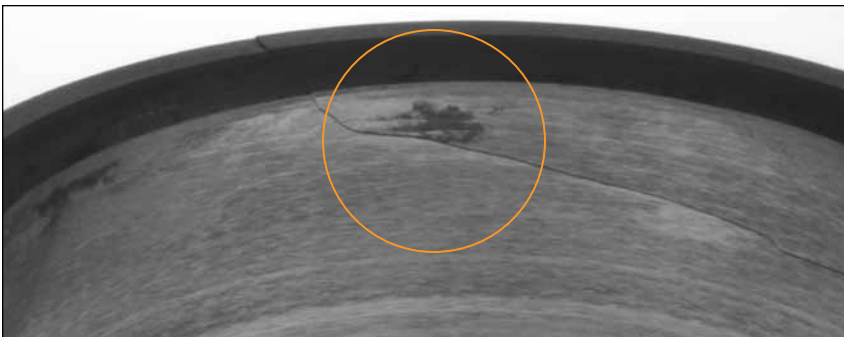
Fig. 52. Esta fractura del anillo interior de un rodamiento de bolas resulta de la instalación sobre escamas de metal contaminantes o sobre una imperfección de metal levantado.
