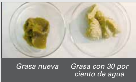
Fig. 74. Aquí se muestra el efecto del agua en la grasa.
