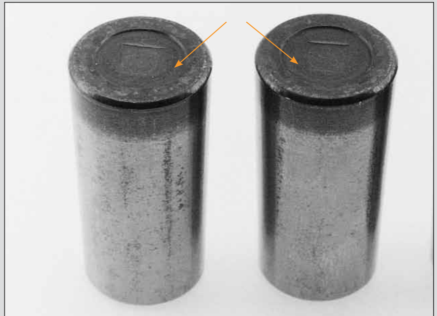
Fig. 20. Nivel 3: el daño por calentamiento en estos rodillos cónicos fue ocasionado por el contacto entre metales.
