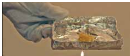
Fig. 78. Una prueba de crepitación determina la presencia de agua en la grasa.
