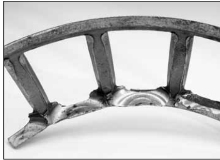
Fig. 33. Orificios de la jaula dañados como resultado del exceso de movimiento de los rodillos.
