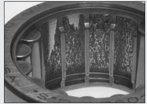
Fig. 38. Anillo exterior de un rodamiento de rodillos cilíndricos con astillamiento por concentración de tensión geométrica y distribución de carga desigual debido a que el diámetro interior del alojamiento fue maquinado con una conicidad incorrecta.
