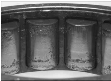
Fig. 26. Rodamiento de rodillos cilíndricos con astillamiento por fatiga originado por cargas pesadas.
