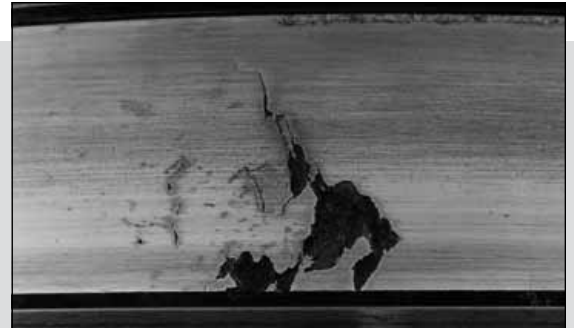
Fig. 23. Desalineación, deflexiones o cargas pesadas en este rodamiento de rodillos cónicos ocasionaron un astillamiento por concentración de tensión geométrica.
