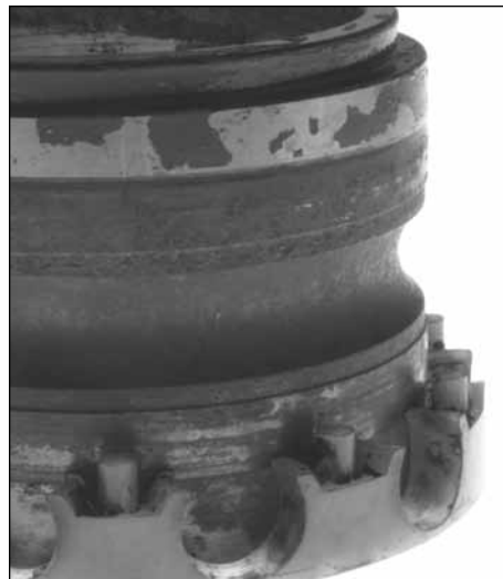
Fig. 15. Anillo y jaula interna del rodamiento de bolas dañados severamente por el agua.
