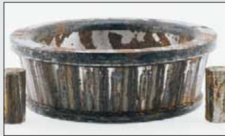
Fig. 75. El cono y los rodillos de un rodamiento de rodillos cónicos, y la pista externa y las bolas de un rodamiento de bolas (Fig. 76) muestran el óxido, las picaduras y la corrosión producto de la exposición a la humedad/agua.
