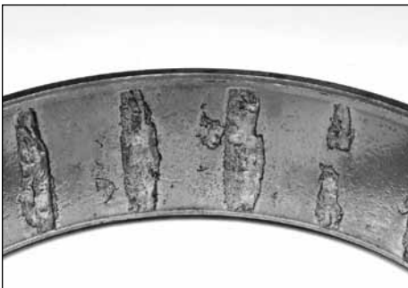
Fig. 14. Descascarillado avanzado originado por marcas de agua en la pista de la taza que deja inutilizable el rodamiento.
