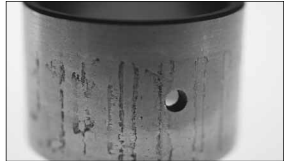
Fig. 13. El anillo interior del rodamiento cilíndrico presenta signos de manchado y corrosión.
