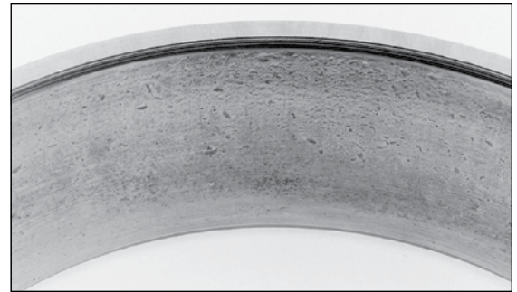
Fig. 7. La suciedad de otras piezas fatigadas, el sellado inadecuado o el escaso mantenimiento provocaron abolladuras en esta pista de rodamiento de rodillos cónicos.
