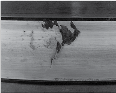
Fig. 5. Pista interna (cono) de un rodamiento de rodillos cónicos astillada debido a abolladuras por contaminación.
