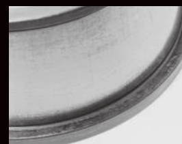
Повреждение бурты и торцов роликов вследствие перегрева
