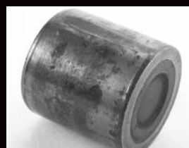
Фаски на роликах, адгезивный износ и износ от скольжения на поверхности дорожки качения
