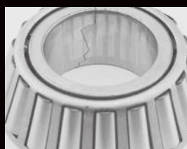
Трещина во внутреннем кольце
