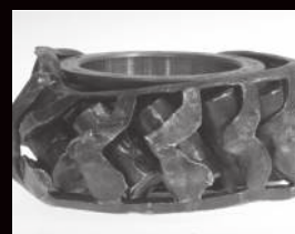
Деформация дорожки качения из-за сильного нагрева
