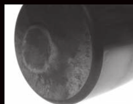
Адгезивный износ торца ролика
