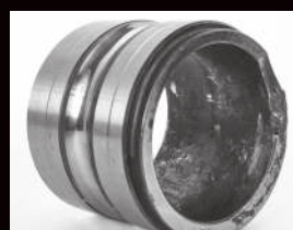
Трещины в широкой внутренней облате со стопорным кольцом из-за недостаточного размера вала
