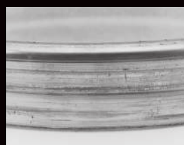
Свободная посадка наружного кольца в ступице колеса
