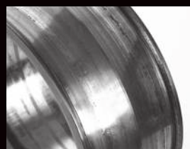
Адгезивный износ внутреннего кольца подшипника
