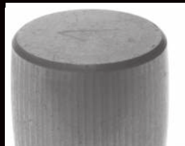
Рифление вследствие ожогов, вызванных электрическим током
