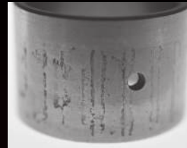
Травление и коррозия
