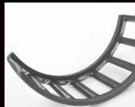
Износ узких сторон окон и перемычек сепаратора
