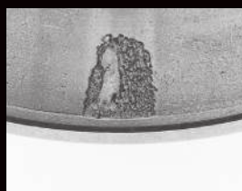
Характерное локальное выкрашивание на дорожке качения
