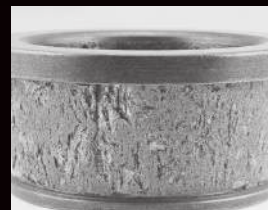
Сильное отшелушивание и выкрашивание вследствие больших нагрузок
