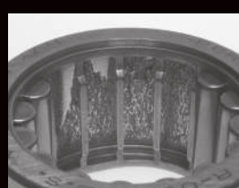
Геометрическая концентрация напряжений (выкрашивание) на наружном кольце
