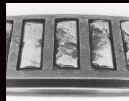
Сильное усталостное выкрашивание роликов из-за большой нагрузки
