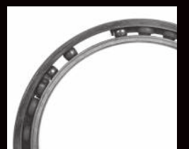
Повреждение сепаратора вследствие заклинивания подшипника
