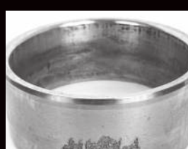
Геометрическая концентрация напряжений (выкрашивание) на внутреннем кольце
