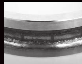
Усталостное выкрашивание вследствие сильного преднатяга
