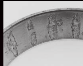
Выкрашивание участками с шагом, равным расстоянию между роликами
