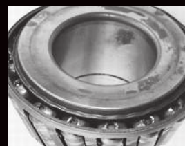
Задир на торцах роликов
