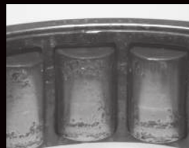
Усталостное выкрашивание вследствие больших нагрузок
