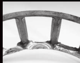
Износ окна сепаратора из-за неравномерного движения роликов осевого зазора
