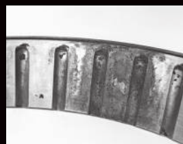
Сильное ложное бринеллирование на наружной дорожке качения
