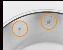
Вмятины на шагом, равным расстоянию между роликами
