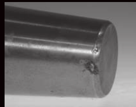
Ролик с электроэрозионными ожогами
