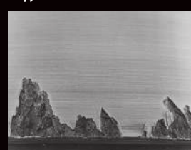
Геометрическая концентрация напряжений (выкрашивание)
