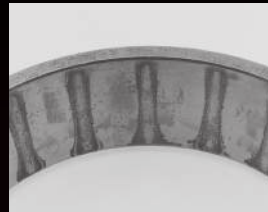
Легкая коррозия на наружном кольце
