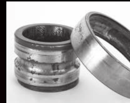
Сильная коррозия и травление
