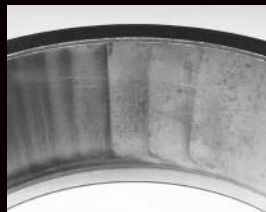
Волнообразный износ наружного кольца из-за увеличенного осевого зазора
